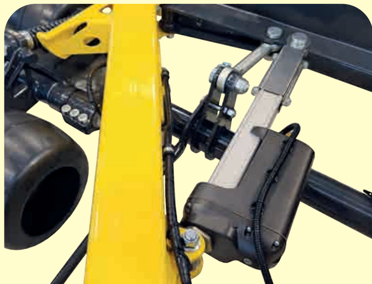
Réglage électrique des essieux tandem Option pour ST 1150 - ST 1000 - ST 920 - ST 870 - ST 730 Standard pour ST 380
