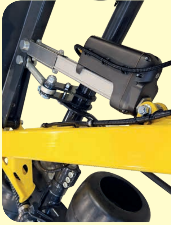
Ajuste eléctrico ruedas tándem Opcional para ST 1150 - ST 1000 - ST 920 - ST 870 - ST 730 De serie en ST 380
