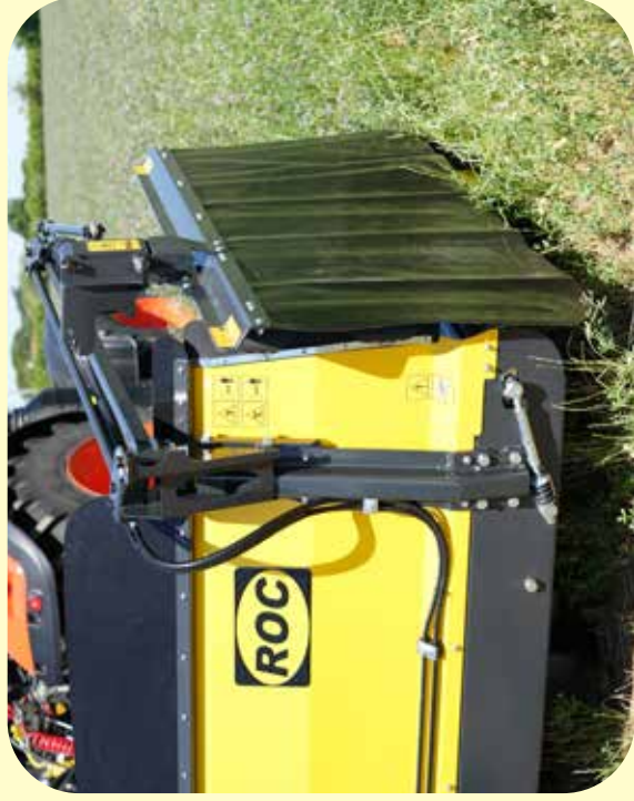
Lona hileradora hidráulica - lado derecho Opcional para los modelos ST 1150 - ST 1000 - ST 920 - ST 870 - ST 730
